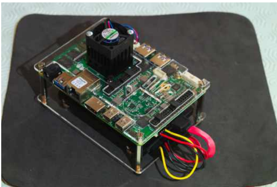
Fig. 8 - SBC UdooX86 Ultra con case in acrilico modificato da Stefano Colonna
